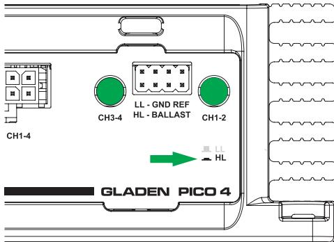
**Ingressi ad alto livello** - Inserire i ponticelli per collegare un carico virtuale ai singoli canali d'ingresso analogici.
