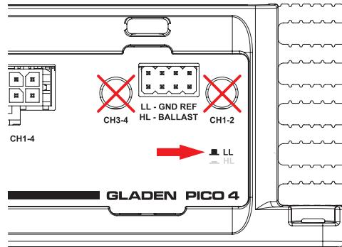
**Ingressi a basso livello** - i ponticelli devono essere utilizzati solo se la sorgente del segnale esterno non è alimentata dalla batteria dell'auto, ad esempio DAP, smartphone, ecc... L'uso di ponticelli in una configurazione diversa può causare loop di massa e ronzi.
