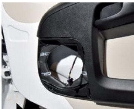
1 Der Original-Fiatlautsprecher ist demon- tiert, der Einbaurahmen mit einer Dämm- Matte ausgekleidet (Lieferumfang.)
