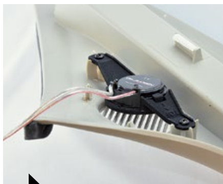
2 Schön zu sehen: Die speziell für die Remis-Verkleidung geformten Haltearme des Gladen-Hochtöners. Effekt: perfekter Abstrahlwinkel.
